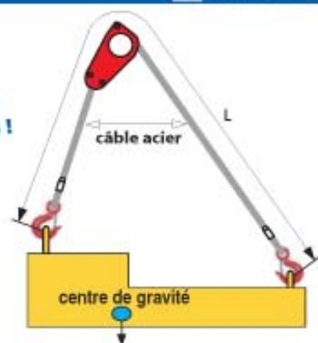
En position libre, élingue étendue, le câble circule autour du tube de la tête d'équilibrage, pour la déplacer et la positionner au dessus du CENTRE DE GRAVITÉ supposé de la charge.
